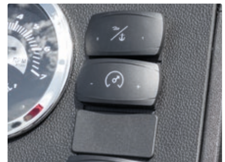
Trolling Control Uistelutoiminnon ansiosta perämootorin kierros-lukua voidaan hienosäätää 50 kierroksen välein tyhjäkäynnistä aina 900 kierrokseen asti.
